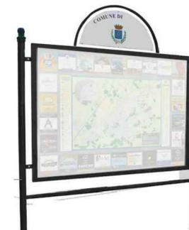
Struttura portante con 2 sostegni laterali ed estremità decorativa in ghisa. Pannello unico in lamiera 20/10 di dimensioni 130x190 cm. Struttura verniciata a forno in polvere epossidica color grigio.
